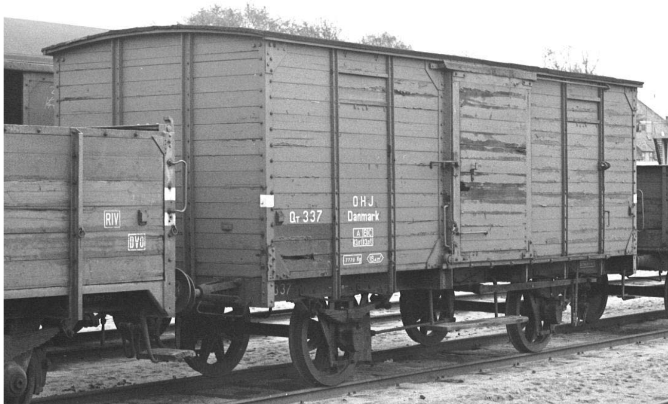
OHJ QT 337, i uændret original tilstand (på nær H-bremser), med tara 7770 kg, ABC-last 13,0 t og Bdf1 18,4 m 2 . Holbæk 02.11.1974 © Per Topp Nielsen
