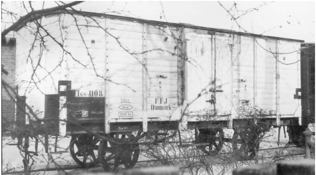
FFJ Igs 1108, isoleret med fløjdøre, tara 8440 kg, last 12,5 t og bundfladeareal 16,9 m 2 . Foto Finn Sørensen 196x
