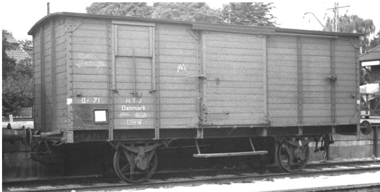
HTJ Qt 71, med tara 7520 kg, Last 12,5 t og Bdf1 18,2 m 2 . Hellerup 17.09.1961 © H.B.D.Sørensen
